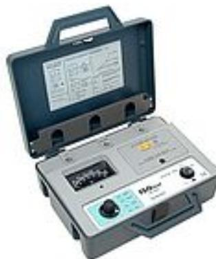
可用于绝缘电阻的测量，电压范围 0.5 kV, 1 kV, 2.5kV 和 5kV。还可用于直流/交流 600V 以内电压的测量。该测试仪的设计充分考虑了相关安全标准。其电源为电池 (4 x 1.5 Vdc.IEC R20)，正常条件下自动测量可达 2000-2500 次。外壳是发泡塑料，绝缘性能很好。
